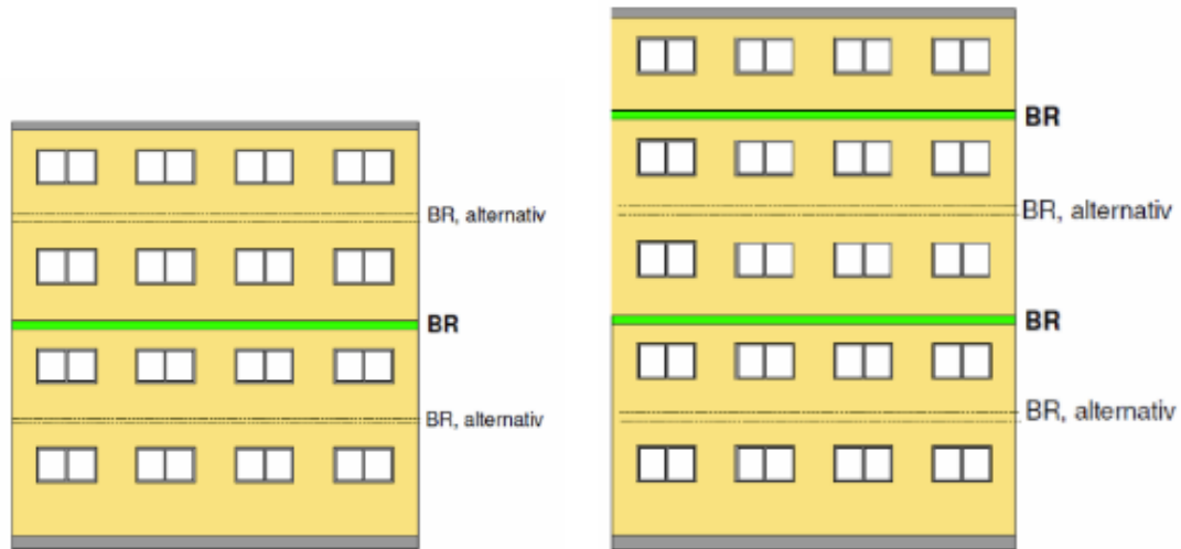
Brandsperrn im Bereich der Geschossdecken
