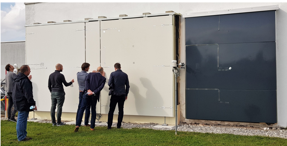
Freilandversuchsstand am Fraunhofer IBP: Versuchsfassade mit Beton- und Metallprototypen für die Untersuchungen im Freiland; BMWi-Forschungsvorhaben „Solar-VHF“; Foto: Ronald Winterfeld, FVHF e.V.
