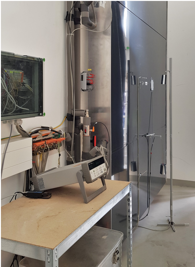
Technikum Fraunhofer IBP: Versuchsfassade aus Metall für Indoor-Tests (inkl. Messtechnik); BMWi-Forschungsvorhaben „Solar-VHF“; Foto: Ronald Winterfeld, FVHF e.V.
